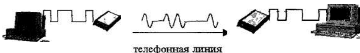
Рис. 2. Подключение по телефонной линии с помощью модема
